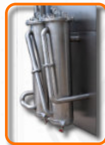
Sistema de doble filtrado: 50-25 µm
