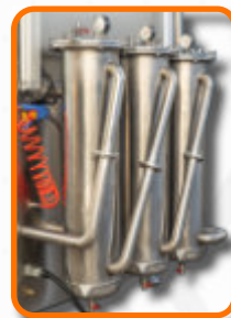
Sistema de triple filtrado: 50-25-5 \mu m
